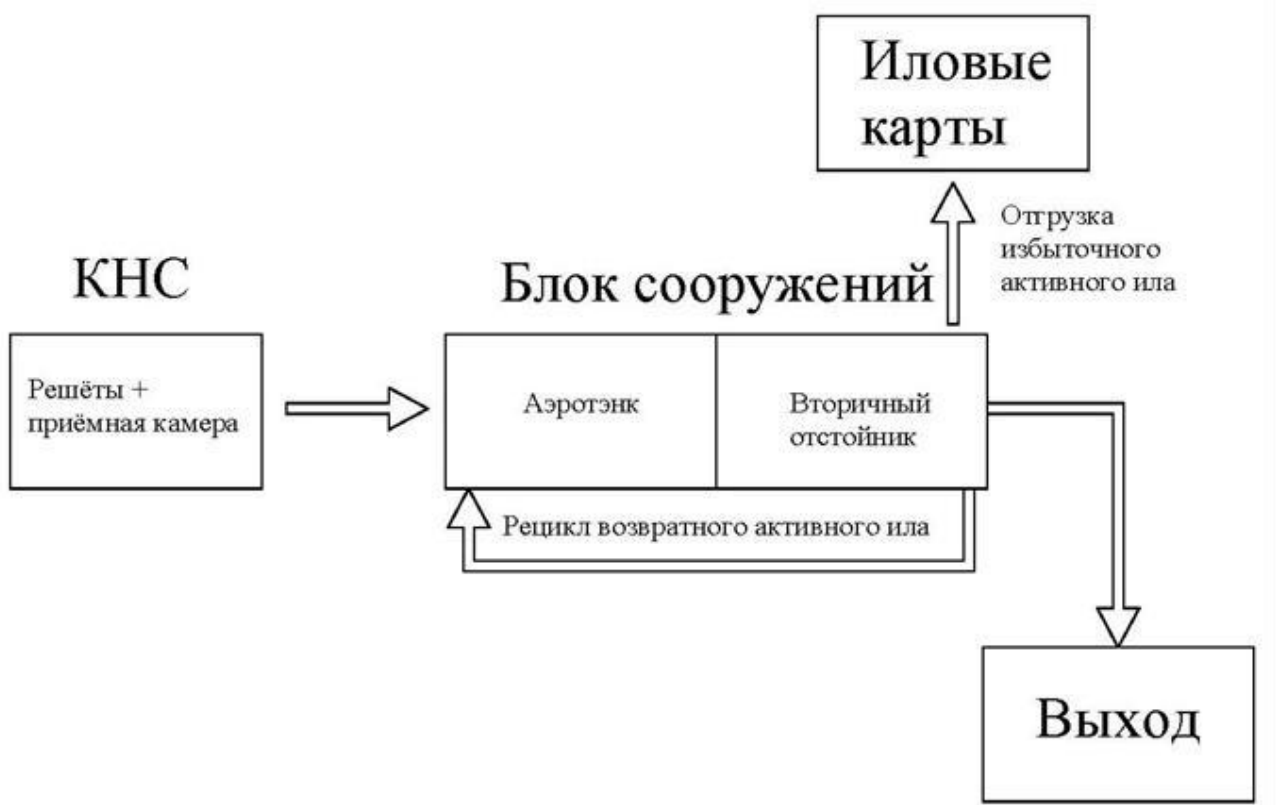
Рисунок 39. Принципиальная технологическая схема очистки
