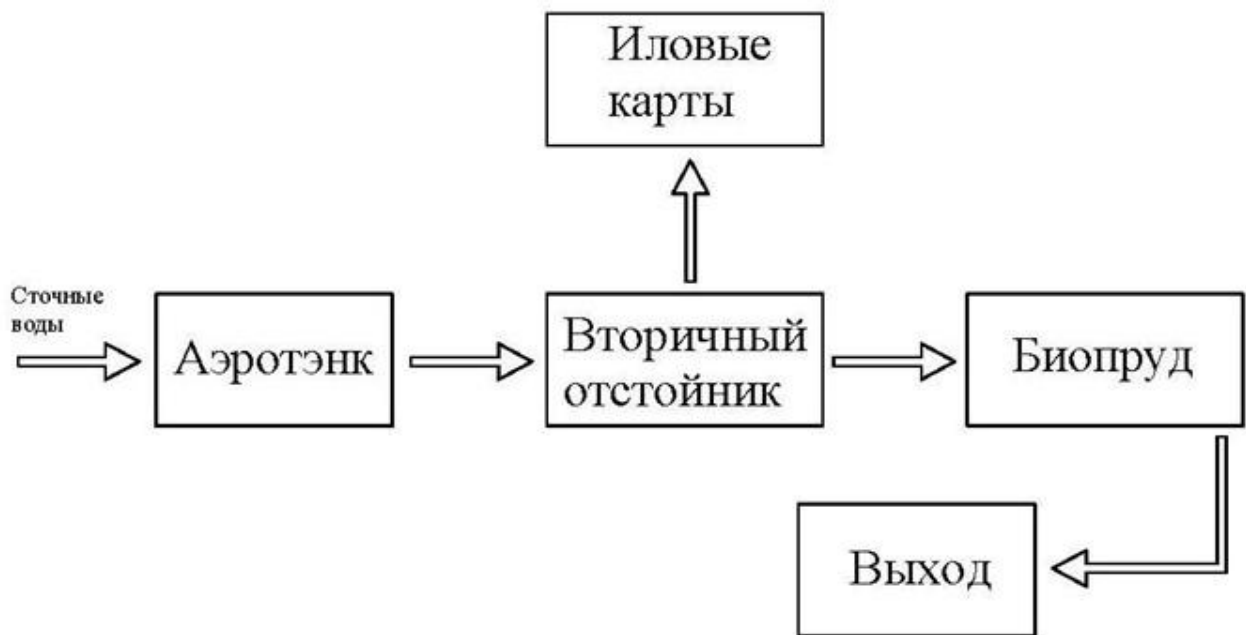
Рисунок 35. Принципиальная технологическая схема очистки
