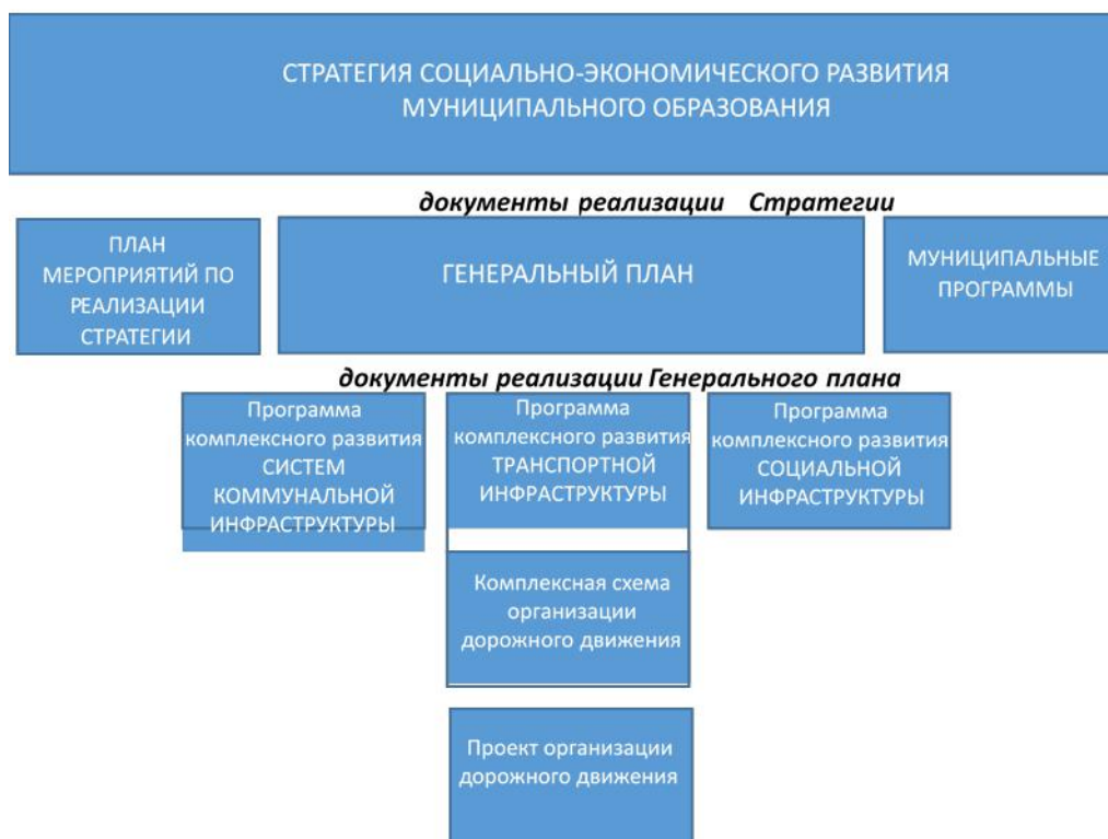
Рисунок 24 - Место комплексной схемы организации дорожного движения в структуре документов, определяющих развитие муниципального образования
